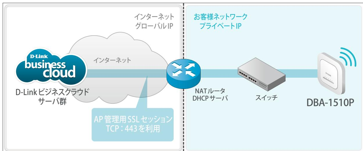
図 6-30 クラウド接続におけるネットワーク構成
