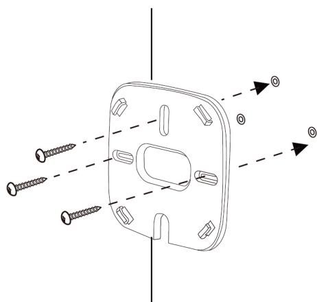
図 3-7 マウンティングリングネジ止め
