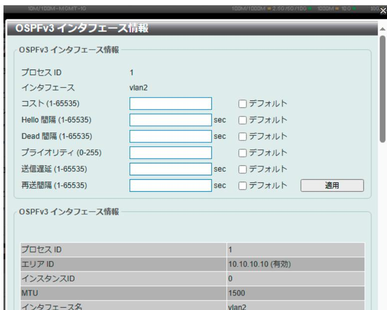
図 9-59 OSPFv3 インタフェース設定（プロセス ID）画面
