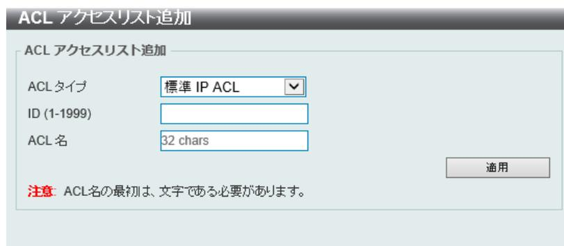
図 11-14 ACL アクセスリスト追加 (標準 IP ACL) 画面
