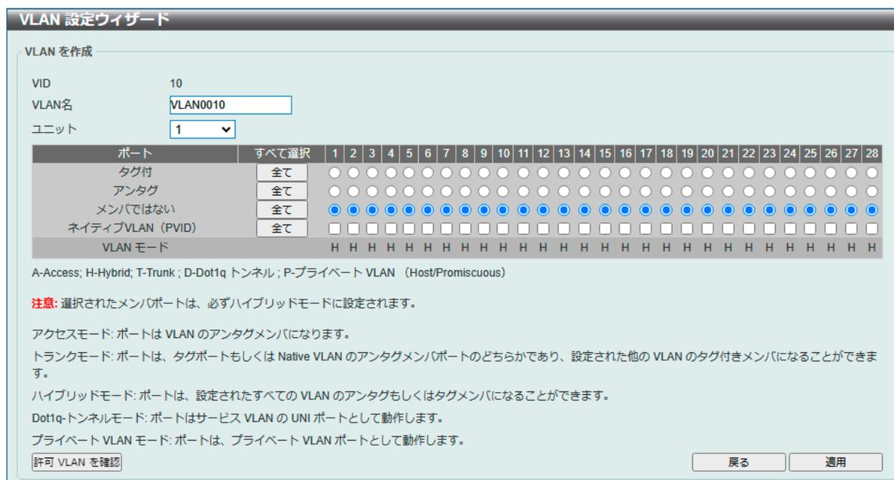
図 8-5 VLAN 設定ウィザード画面
