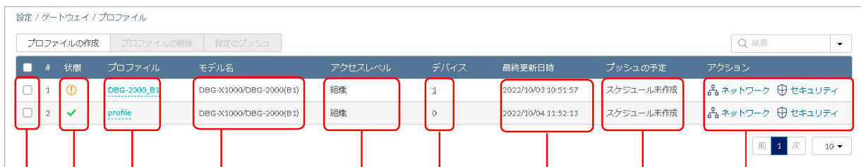
図 5-12 プロファイルリスト ①チェックボックス ②状態 ③プロファイル ④モデル名 ⑤アクセスレベル ⑥デバイス ⑦最終更新日時 ⑧プッシュの予定 ⑨アクション
