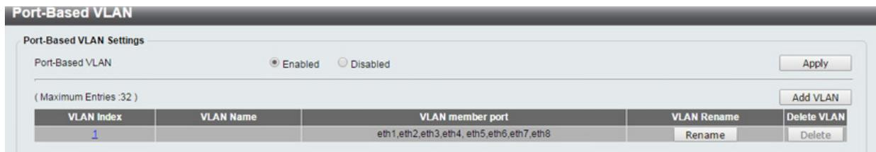
図 8-9 Port-based VLAN (Enabled) 画面
