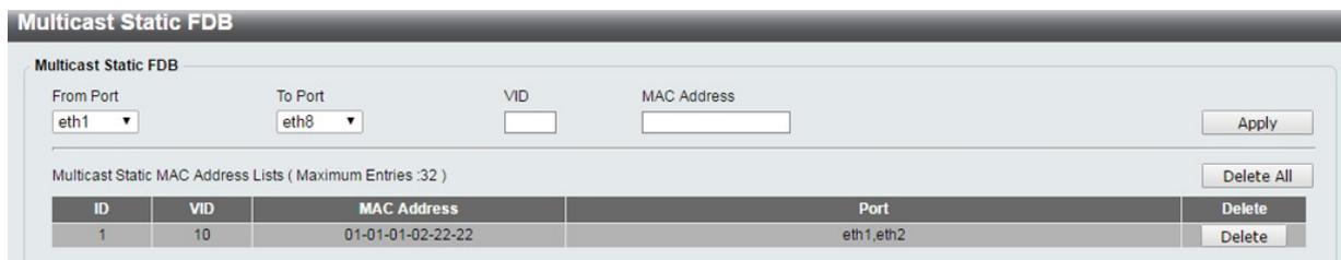
図 8-2 Multicast Static FDB 設定
