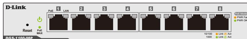
図 1-3 DGS-1100-08P の前面パネル図
